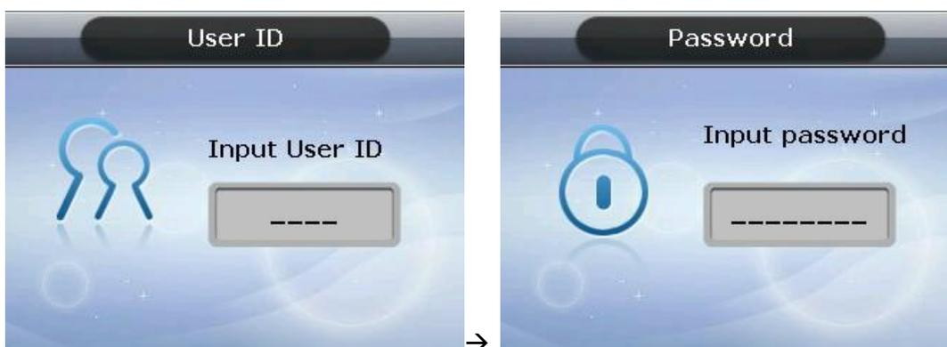
Appuyez sur [ENT] après avoir introduit l'ID, l'écran pour la saisie du mot de passe apparaît. Si un chiffre erroné est introduit, appuyez sur [F4(←)] pour effacer. Introduisez le mot de passe et pressez [ENT].
