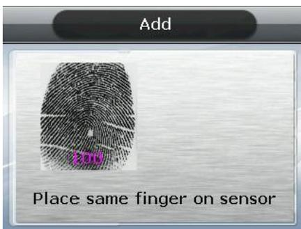
② Si le message 'Place same finger on sensor' (Placez le même doigt sur le senseur) s'affiche, placez à nouveau le même doigt sur le capteur comme ci-dessus.
