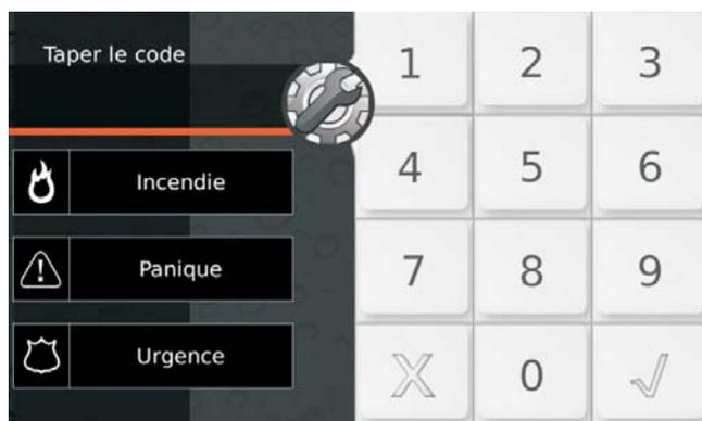
**Figure 25** Étiquettes par défaut des SuperTouches du Clavier Touch.
