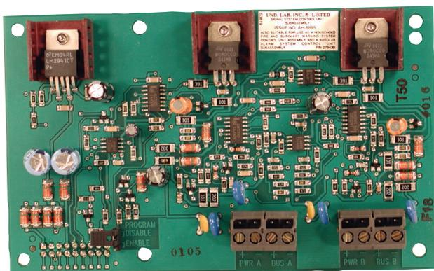
Le DS7436 est un module d'extension multiplex à deux boucles compatible avec les centrales d'alarme série DS7400Xi. Il se connecte directement à la centrale DS7400Xi et comprend un bus multiplex bifilaire pour relier jusqu'à 120 points distants. Chaque bus est isolé pour qu'une défaillance de l'un n'en entraîne pas chez les autres.
