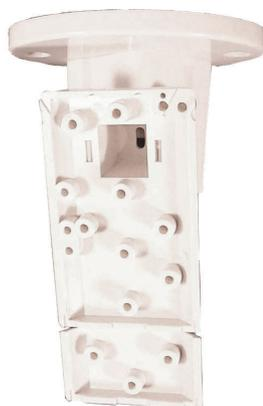
Montez le support plastique B338 en surface au plafond. Il peut être utilisé avec de nombreux types de détecteur. L'angle de pivotement vertical est compris entre +7° et -16° ; l'angle de rotation horizontal est de +/-45°.
