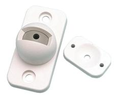
Montez le support compact plastique en saillie sur le mur. Il peut être utilisé avec de nombreux types de détecteur. L'angle de pivotement vertical est compris entre +10° et -20°; l'angle de rotation horizontal est de ±25°.
