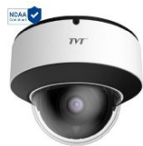
Outdoor dome 2.8mm • S4 • 4 MP (2560 x 1440) • IP • Starlight 0.005 Lux@F1.6 • AI: VSA 1.0-Tampering Detectie • IR correctie lens 2.8mm f/1.6 • 94° • WDR 120dB • Infrarood tot 30m • H265-H264-MJPEG • 25 Beelden/sec. • IP67-IK10 • PoE: IEEE 802.3af Klasse 3 • Verbruik: max. 5.5W • Andere voeding: Vcc : 12 V +/-10 % • Temp: -30° C tot + 60° C • Audio: interne microfoon • Alarm: niet beschikbaar • SD card: niet beschikbaar • Onvif-NDAA • Kleur: Wit
